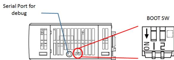
CONPROSYSのコンソールをPCから制御できるようにCONPROSYSの専用シリアルポート(3.5Φミニジャック)にシリアルケーブルをPCに接続します。シリアルの設定は次のようになります。
