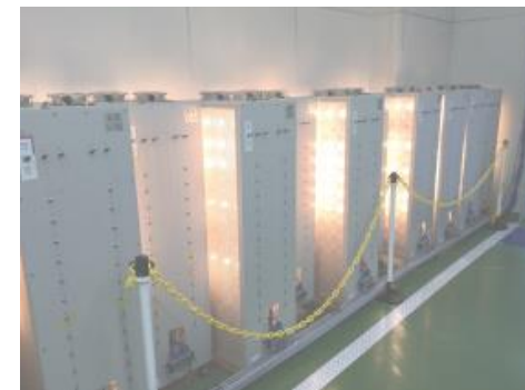
電球による負荷試験
