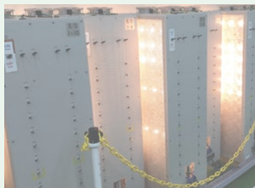
電球による負荷試験
