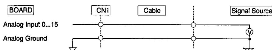
別売の同軸ケーブル(PCC16PS)などのシールドケーブルを使用した接続例です。信号源とボードの距離が長い場合や、耐ノイズ性を大きくしたいときに使用してください。CN1の各アナログ入力チャネルに対して、芯線を信号線に、シールド編組をグランドに接続します。
