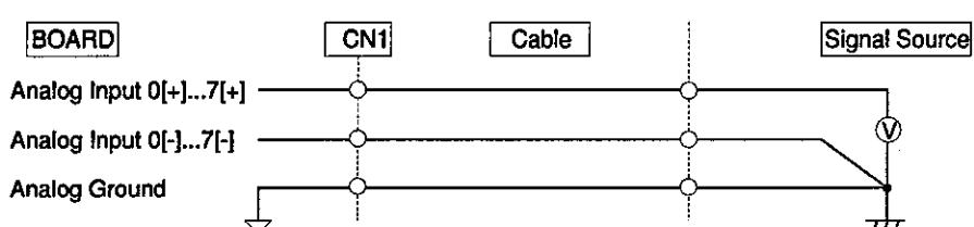
別売の2芯シールドケーブル(PCD8PS)などのシールドケーブルを使用した接続例です。信号源とボードの距離が長い場合や、耐ノイズ性を大きくしたいときに使用してください。CN1の各アナログ入力チャネルの[+]入力を信号に接続し、[-]入力を信号源のグランドを接続します。さらに、ボードのアナロググランドと信号源のグランドをシールド編組で接続します。
