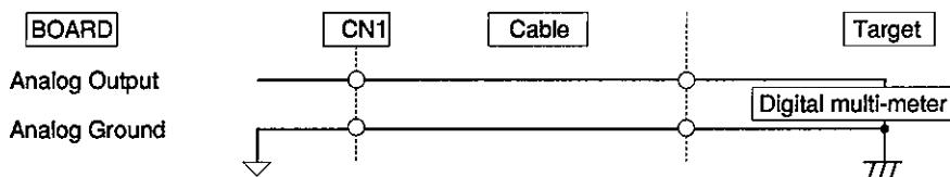
シールドケーブルを使用した接続例です。信号源とボードの距離が長い場合や、耐ノイズ性を大きくしたいときに使用してください。CN1のアナログ出力に対して、芯線を信号線に、シールド編組をグランドに接続します。
