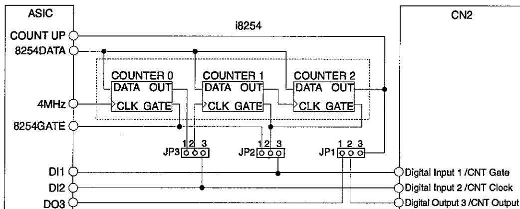
注1) カウンタの制御を行う外部信号には、TTLレベルの信号を使用してください。
