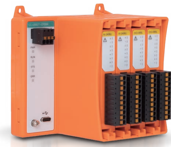
※写真は4つのI/Oモジュールを実装した構成例
