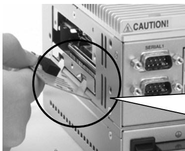
図2.1 HDDブラケットの取り外し
