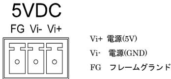
図2.2 +5VDC入力端子のピン配列
