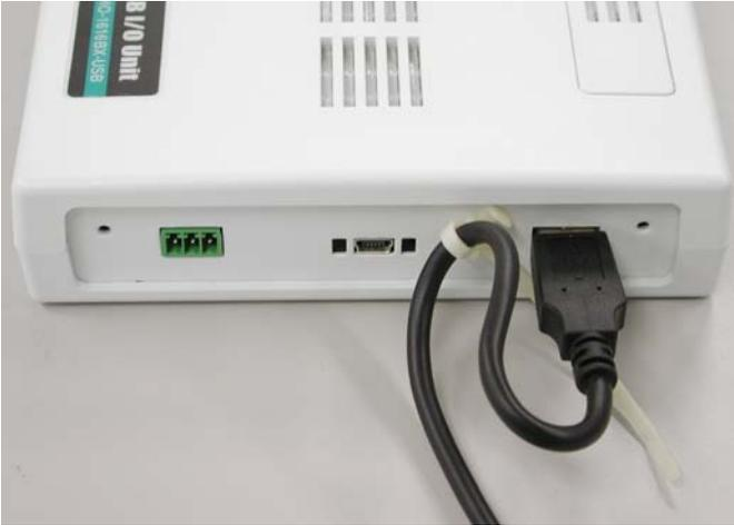
図2.6 本体側USBケーブル抜け防止用クランプの取り付け
