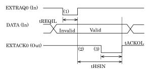
tREQIL : EXTREQ0 low width 50ns (Min.) tACKOL : EXTACK0 low width 100ns tHSIN : Handshaking time 100ns (Min.)
