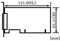
標準外形寸法の(L)は、基板の端からスロットカバーの外側の面までのサイズです。
