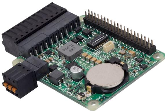
本製品は、Raspberry Pi に RAS 機能および RTC 機能、8 - 28VDC 電源入力機能を増設する拡張ボードです。
