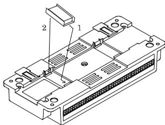
本製品は、CONPROSYS Series コンパクトタイプを金属面に設置するためのマグネットです。
