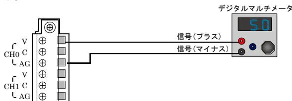
モジュールと外部機器との距離が長い場合や、耐ノイズ性を大きくしたいときは、同軸ケーブルを使用してください。各チャンネルの電圧出力とアナロググランドを、同軸ケーブルの芯線とシールド編組で、それぞれ外部機器の入力とグランドに接続します。
