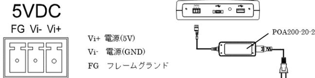
同梱の電源用コネクタ(MC1,5/3-ST-3,5、対応ケーブル: AWG28 - 16)を使用して電源を供給する場合は、対応ケーブルの先端を剥き、電源用コネクタに挿入した状態でしっかりねじ止めしてください。
