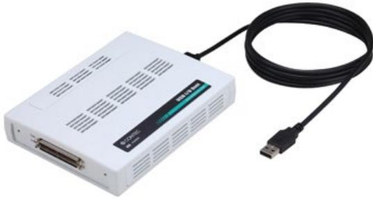
本製品は、パソコンにデジタル信号の入出力機能を拡張する USB2.0 対応のデジタル入出力ユニットです。
