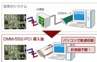
■パソコンからの直接制御でタクトタイムを大幅に短縮
