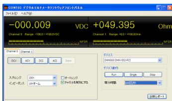
本製品は、高精度 5 1/2 桁、2チャンネル同時計測可能な PCIバス対応のデジタルマルチメータボードです。直流電圧/電流、交流電圧/電流、抵抗の5つの測定機能を備えています。
