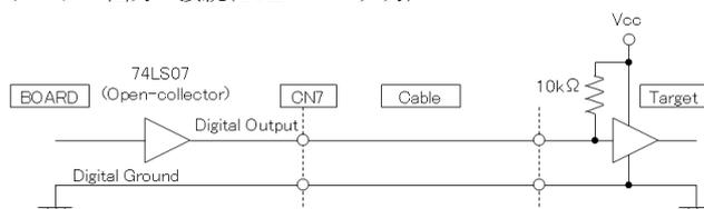
デジタル出力信号の接続先で信号線がプルアップされていない場合は、外部にプルアップ抵抗を接続する必要があります。
