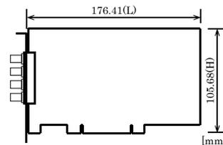
外形寸法の(L)は、基板の端からスロットカバーの外側の面までのサイズです。
