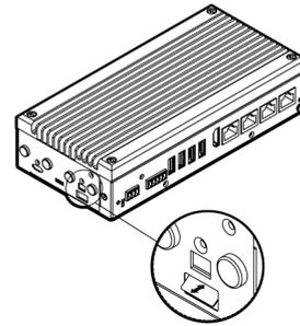
2. FAN のコネクタを FAN 用コネクタ部に差し込み、同梱の固定ねじを使用して DX-U2000 シリーズ本体に取り付けます。
