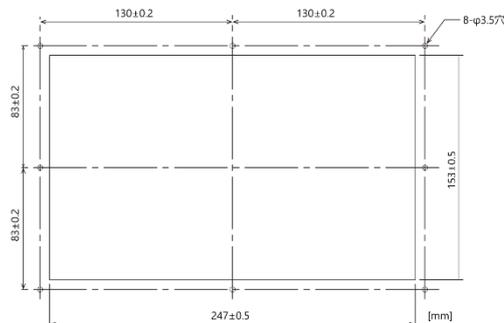
2 パネルの外側から FPD-V11WB-10 をはめ込みます。防塵・防滴性能を満足するには、防水ガスケットを PD-V11WB-10 本体の溝に嵌めた上で取り付けてください。
