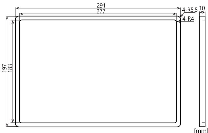
FPD-V11WB-10 をパネルの外側から取り付ける際に使用する防水ガスケットです。
