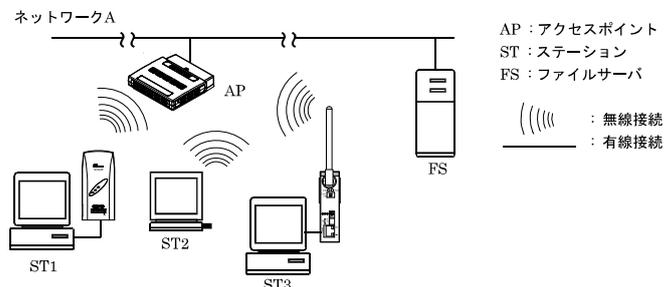
上記のコンパチブル・インフラストラクチャモードでは、スタンダード・インフラストラクチャモードと同様、すべての無線端末は AP を介して通信を行います。ローミング機能をサポートしていますので、電波の届く範囲なら、どの AP にもログインすることが可能です。
