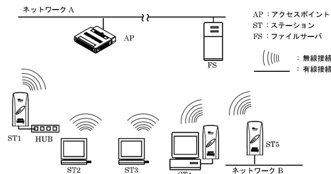
上記のスタンダード・インフラストラクチャモードに設定された端末は、FLEXLAN シリーズ独自の機能を使用できます。
