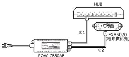
POW-CB50AF の入力側(DATA IN)と HUB(またはパソコン)、出力側(DATA&POWER OUT)と PoE 対応無線 LAN 機器を LAN ケーブルで接続してください。
