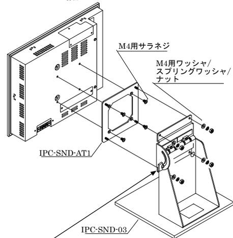
角度調整ロックネジ (ネジを緩めて角度調整してください。)
