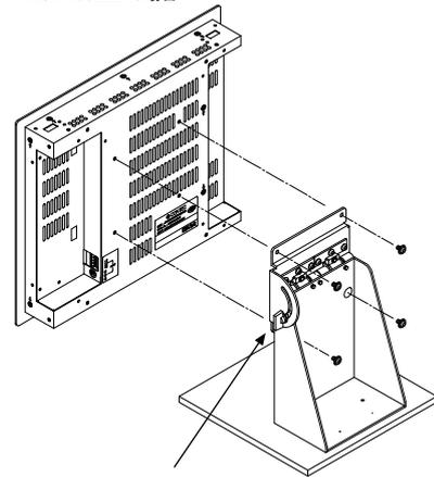
角度調整ロックネジ (ネジを緩めて角度調整してください。)
