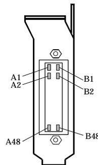
ボード上に実装されているコネクタ品名 PCR-E96LMD (本多通信工業製)
