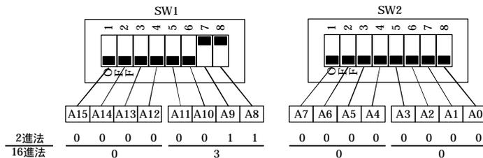
図では先頭I/Oアドレスが0300Hに設定されており、次に示すI/Oアドレスがこのボードによって占有されます。
