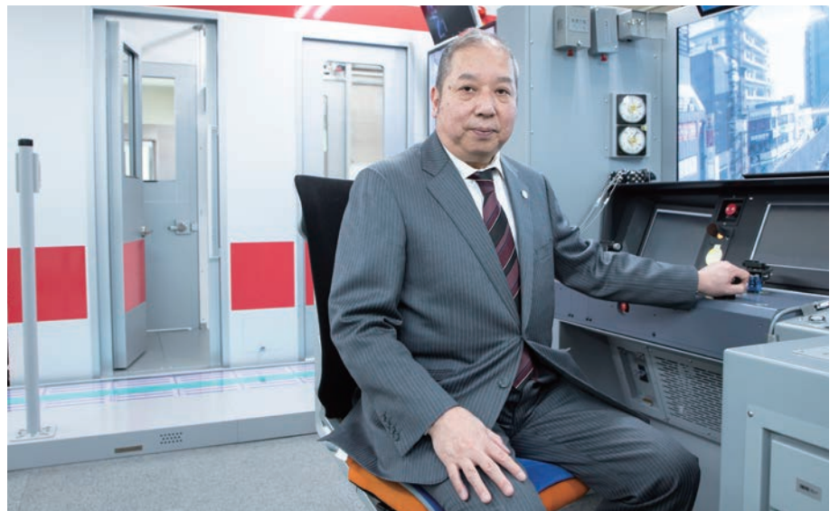
運転士と車掌の連携訓練が可能なシミュレータシステム。実際の業務に準じて、同時に訓練することも、個別に訓練することもできる
