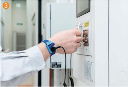
3 リストストラップの端子を差し込み、手でタッチして計測
