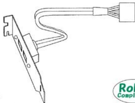
本製品は、当社製シングルボードコンピュータ専用のオプションケーブルです。他社製の機器接続にはご使用になれません。シングルボードコンピュータ基板上にあるUSBインターフェイス(2.54ミリピッチピンヘッダ 10pin コネクタ)をUSBコネクタ(Aタイプ)に変換する際に使用します。
