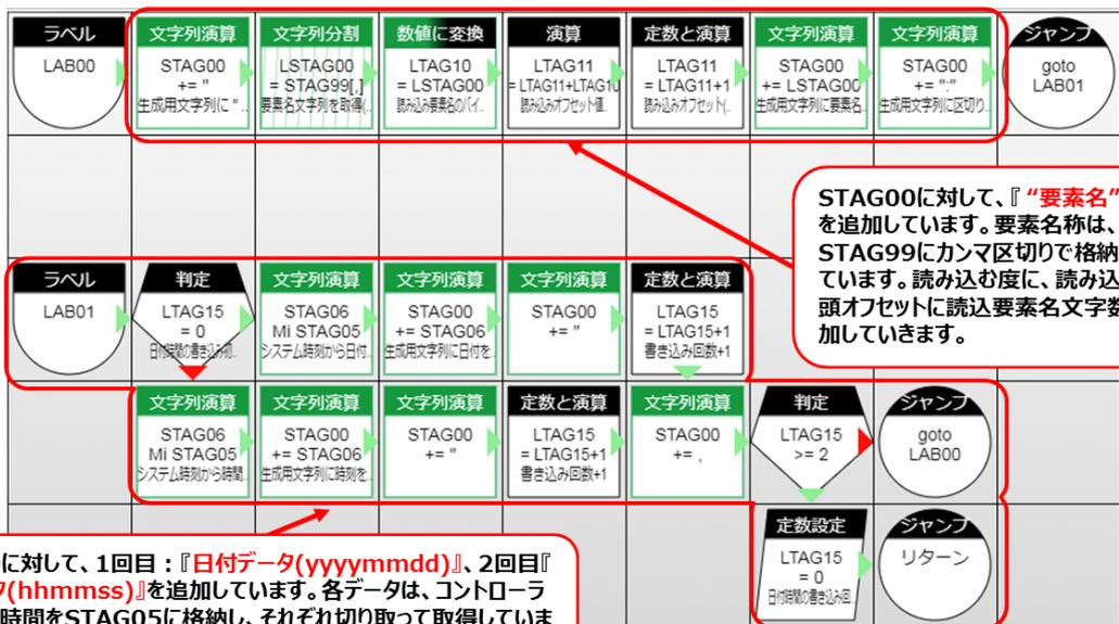
STAG00に対して、1回目：『日付データ(yyyymmdd)』、2回目『時間データ(hhmmss)』を追加しています。各データは、コントローラのシステム時間をSTAG05に格納し、それぞれ切り取って取得しています。STAG05へのデータ代入は、TASK01にて実施しています。
